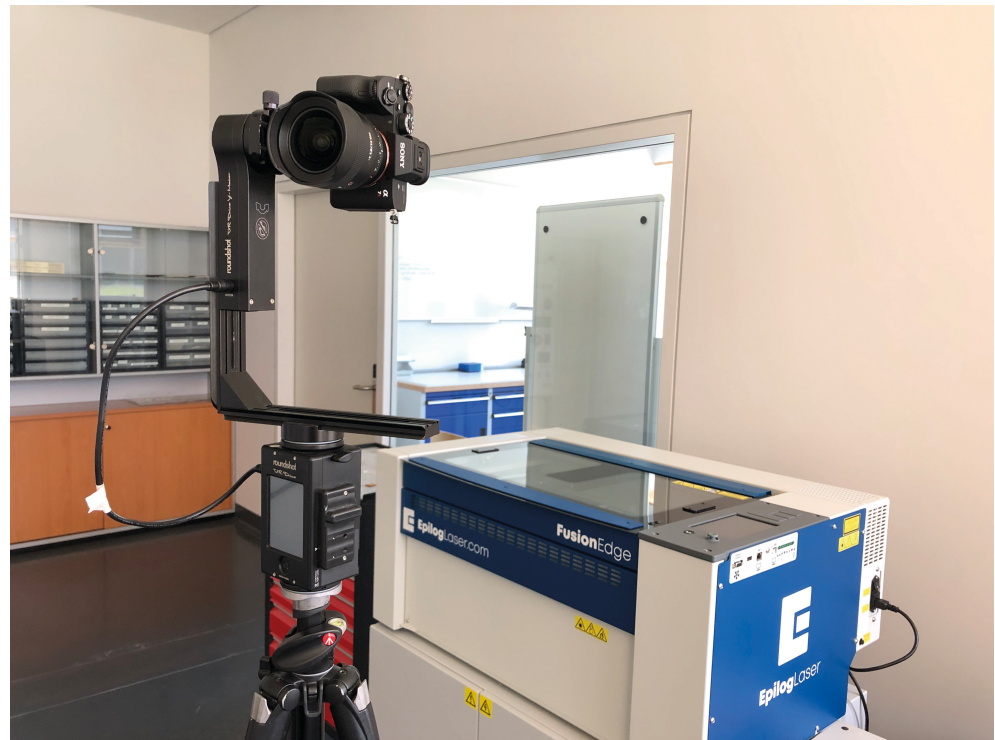
Abb. 2: Kamera und Objektiv montiert auf einem schwenk- und neigbaren Stativ für die Panoramafotografie.
