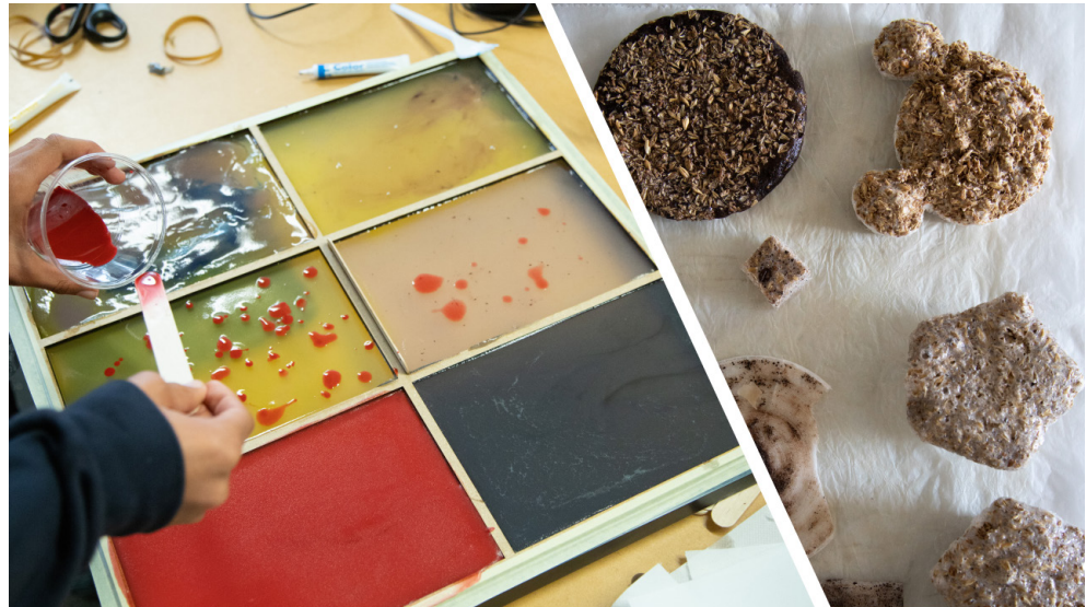
Abb. 2: Herstellung von Materialien aus Biokunststoffen aus Stärke (links) sowie Kaffeesatz und Brauereiabfällen (rechts). (Quelle: www.creativelabz.ch ).
